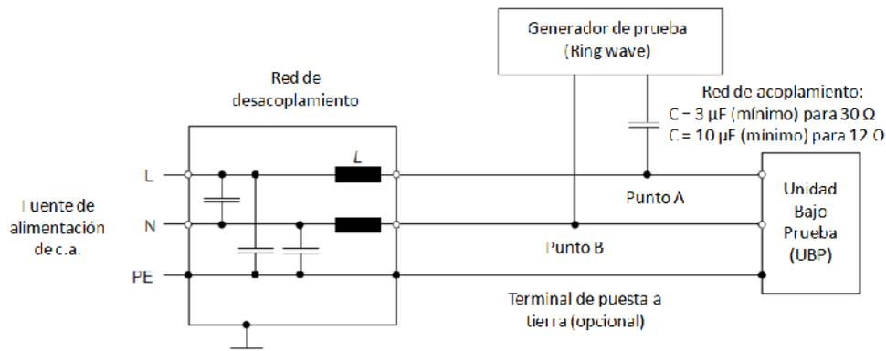
**D.4.2.** Energizar la fuente de alimentación de c.a., así como el generador de prueba.
